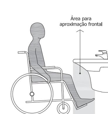
Fig. 2.2.3 Exemplo de aproximação frontal para utilização de lavatório.
