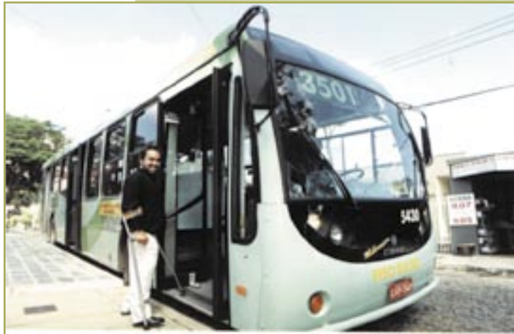
Foto 22 - Microônibus com piso baixo. Embarque ao nível da calçada complementado por rampa basculante do veículo. Campinas, 2006.
