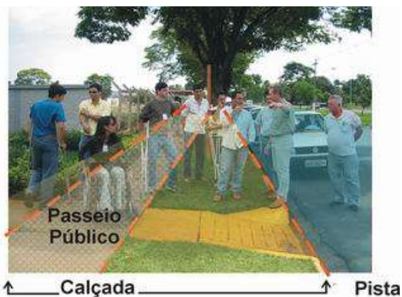
Figura 112 – Perfil de via pública com identificação de suas partes integrantes.
