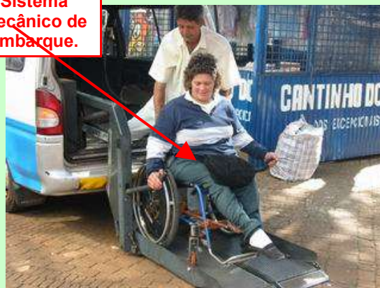
Figura 207 – Sistema de embarque de cadeira de rodas em transporte especial para pessoas com deficiência, com a ajuda do motorista da van, garantindo o acesso seguro (porém não autônomo)
