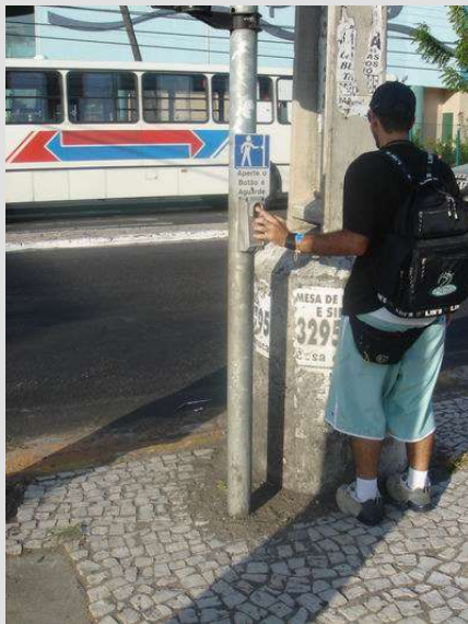
Figura 222 e 223 – Ao lado do suporte da botoeira de acionamento do semáforo temporizado para travessia de pedestres há um poste que impede a passagem. Para se evitar este problema deve-se padronizar o acionamento com a mão direita e implantar um piso tátil de orientação.
